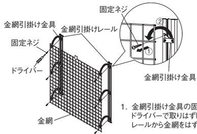
1. 金網引掛け金具の固定ネジをプラスドライバーで取りはずし、金網引掛けレールから金網をはずします。
