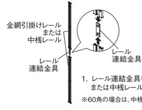
1. レール連結金具を金網引掛けレールまたは中棧レールに差し込みます。
