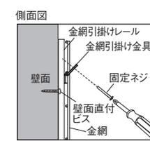
4. 1で取りはずした金網引掛け金具の固定ネジを金網正面から元通りに取り付け、金網を固定します。金網上部の「上」シールをはがします。
