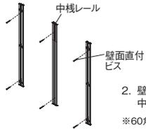
2. 壁面直付ビスで金網引掛けレールと中棧レールを壁面に取り付けます。
