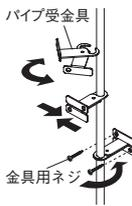
パイプ受金具を中央のパネルの上下の部分(○印の部分)に上記のように取り付け、金具用ネジで固定します。
