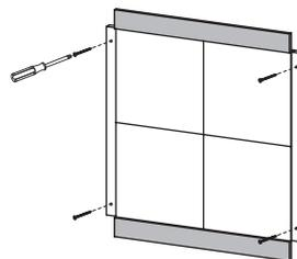
3. 取り付けしたパネルの左右に長い棧を隙間のないように長ネジで取り付けます。
