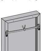
吊金具に吊紐を通して結びます。
