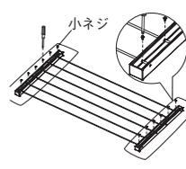
差し込んだパイプの穴に、パイプが抜けないように小ネジを締め込み固定します。
