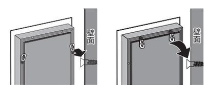
長ビスを壁面に取り付け、吊金具を引掛けます。吊金具を上辺に付け替えることで、側面から吊金具が見えないようになります。
