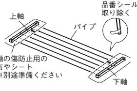
床面に傷防止用の布やシートを敷いて軸を置き、パイプを両方の軸に差し込みます。品番シールがついている側を差し込んだ方を下軸とします。
