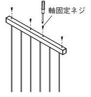
上下の軸を棧に軸固定ネジで固定します。
