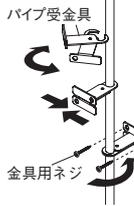
パイプ受金具をパイプの中央部分(○印の部分)に上記のように取り付け、金具用ネジで固定します。
