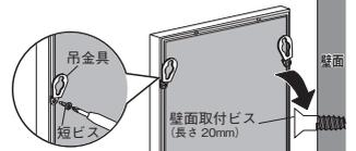
上辺に吊金具を短ビスで取り付けます。
