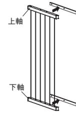
壁に取り付けた棧に、本体を上軸と下軸を考慮しながら前面から取り付けます。
