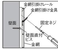
金網引掛け金具の固定ネジを金網正面から取り付け、金網を固定します。
