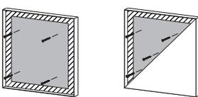
本体の前面のグリーンの間から直接壁面直付ビスで壁に固定します。
