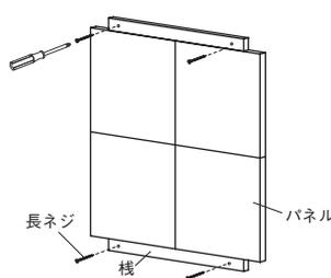
1. 取り付けしたパネルの上下に短い棧を隙間のないように長ネジで取り付けます。
