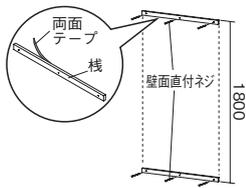
上下の棧の両面テープをはがし、上記のように壁に貼付けた後、壁面直付ネジで固定します。
