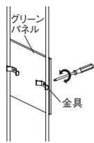
グリーンパネルの裏にある金具のネジを表からゆるめて、パイプに取り付けます。
