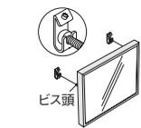
2ウェイフックを壁面に取り付け、ビス頭をフックの穴に引掛けます。
