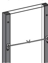
吊金具に吊紐を通して結びます。
