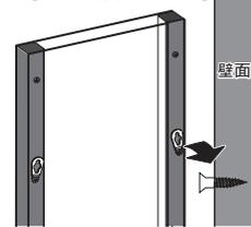
長ビスを壁面に取り付け、吊金具を引掛けます。
