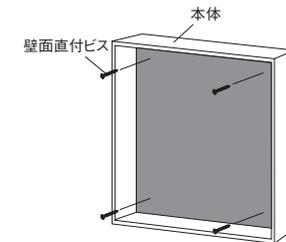
1. グリーンパネルをフレームから取り出し、フレームのみを壁面直付ビスで壁面に固定します。
