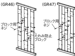
ブロック用ネジを上記のパネルにねじ込み、たわみ防止ブロックの穴に差し込みます。そのまま、ブロック用ネジを壁に取り付けます。
