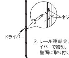
2. レール連結金具のネジをプラスドライバーで締め、レールを連結してから壁面に取り付けます。
