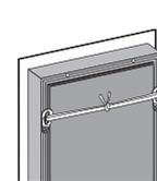
吊金具の穴に吊り紐を通して結びます。
