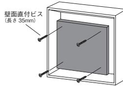
前面のグリーンの間から直接壁面直付ビスで壁に固定します。
