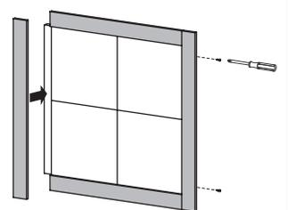
4. 取り付けした左右の棧に長い軸を左右側面から、短ネジで取り付けます。
