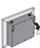
長ビスを壁面に取り付け、吊金具を引掛けます。吊金具を上辺に付け替えることで、側面から吊金具が見えないようになります。
