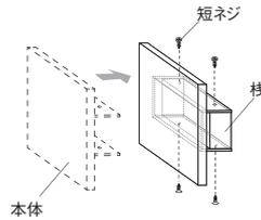
2. 壁面に取り付けた棧に本体をかぶせて、上下の穴から短ネジで固定します。
