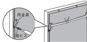
左右の辺に吊金具を短ビスで取り付けます。
