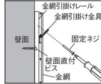
4.1で取りはずした金網引掛け金具の固定ネジを金網正面から元通りに取り付け、金網を固定します。金網上部の「上」シールをはがします。
