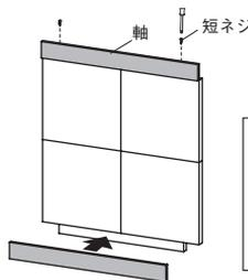
2. 取り付けした上下の棧に短い軸を上下側面から、短ネジで取り付けます。(上下軸だけのタイプはこれで完了です。)
