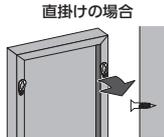
ビスを壁面に取り付け、吊り金具を引掛けます。
