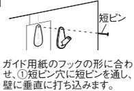
ガイド用紙のフックの形に合わせ、①短ピン穴に短ピンを通し、壁に垂直に打ち込みます。
